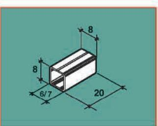
Riduzione per quadro maniglia da 8 mm. a 6 mm. / Follower reducer from 8 mm. to 6 mm. spindle hole.
