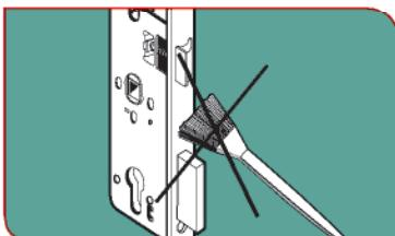
Non verniciare il frontale delle serrature: si potrebbe causare malfunzionamento di scrocco e catenaccio.
