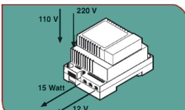
Le serrature elettriche utilizzano alimentazione a 12 Volt 15 Watt. Ove necessario utilizzare adeguati trasformatori.
