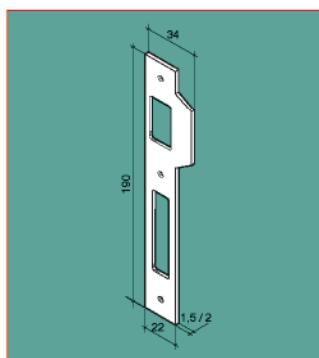
Contropiastra piana in acciaio con ala, spessore 1,5 mm. Bordo quadro e scrocco con spigolo diritto. Catenaccio singolo.
