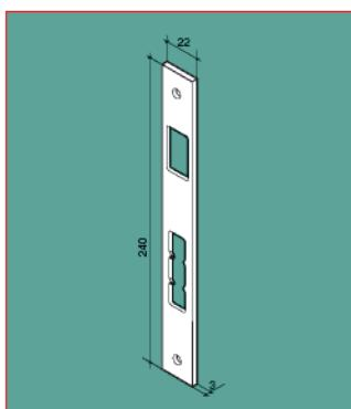
Contropiastra piana in ottone, spessore 3 mm. Heavy brass flat strike, 3 mm. thickness. Bordo quadro e scrocco con spigolo diritto. Square corner and straight latchbolt. Catenaccio triplo.
