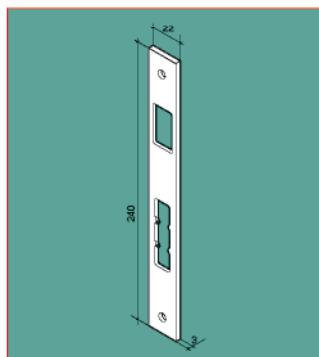
Contropiastra piana in acciaio, spessore 3 mm. Bordo quadro e scrocco con spigolo diritto. Catenaccio triplo.
