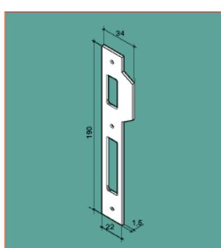
Contropiastra piana in acciaio con ala, spessore 1,5 mm. Bordo quadro e scrocco con spigolo smussato o rullo. Catenaccio singolo.
